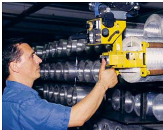
Les bobines sont désormais déplacées à l'aide d'un engin de manutention (équilibreur). La mécanisation a rendu le travail beaucoup plus sûr, plus sain et plus économique.
