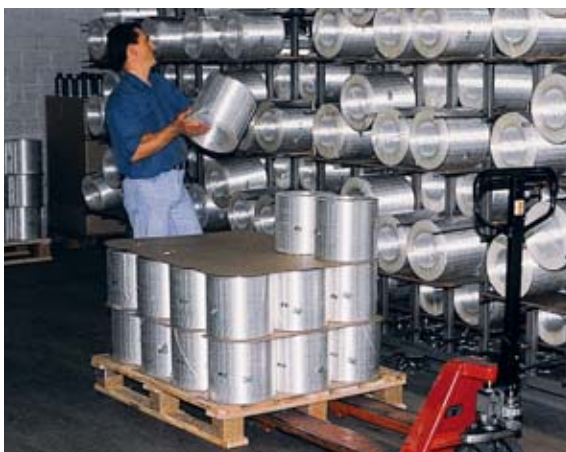
Auparavant, les bobines de fibres optiques de 25 kg étaient transportées manuellement pour leur traitement ultérieur.
