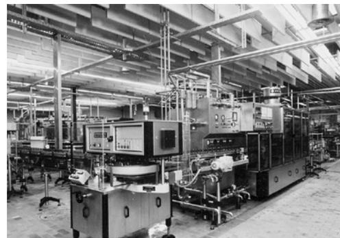
5 Baffle costituiti da pannelli di lana minerale in una ditta produttrice di bevande (impianto di imbottigliamento)
